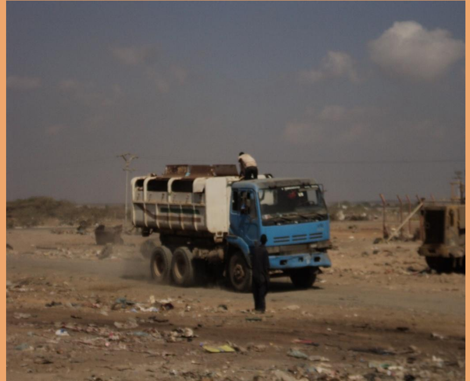
Camions bennes multiples transportant le bac de 12 m 3 à la décharge
