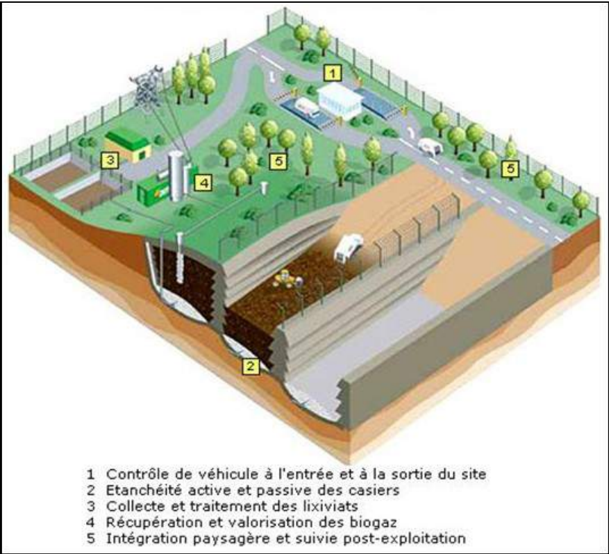
Schéma d'un centre d'enfouissement technique, établi par Véolia
